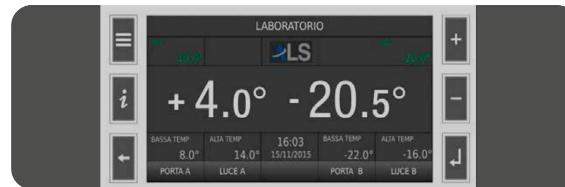
La serie **EMOPLASMABANK** è dotata di due compressori separati, uno per ciascun vano. Ogni compressore è controllato da un controllore a microprocessore dedicato. Per alcuni modelli, per ragioni di spazio, non è possibile installare i due display touch da 7". Su tali modelli è presente un solo display da 7", che però è in grado di pilotare separatamente i due compressori in maniera indipendente.
